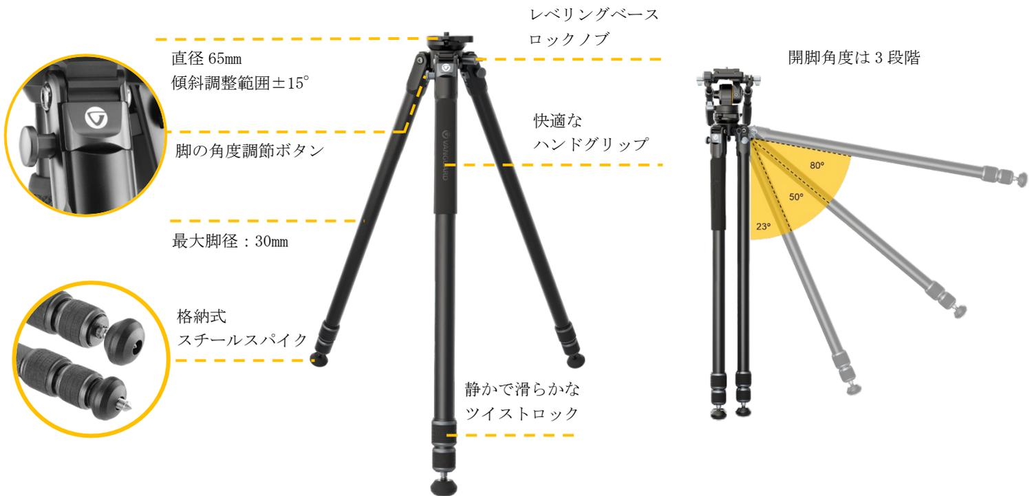
CNC 機械加工されたレベリングベースは、正確なコントロールと柔軟性を実現し、どんな地形でも脚を調整せずに数秒でカメラを地面と平行に保てるように設計されています。レベリングベース部の耐荷重は最大 25Kg
