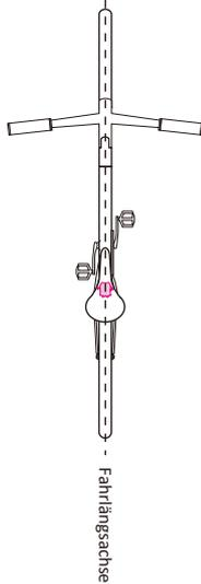
Diese Lampe ist für den Einsatz am Fahrrad bestimmt, dessen Sattelstütze im 73 Grad Winkel steht. Die Anbauhöhe liegt zwischen 250 mm und 1200 mm. Wenn Sie die Höhe der Sattelstütze ändern dann ändert das die Montagehöhe der Lampe.
