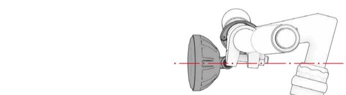
Bei zu geringen Lenkerdurchmesser (31.8 mm), verwenden Sie bitte die mitgelieferte Gummiauflage (35.4 mm to 31.8 mm).
