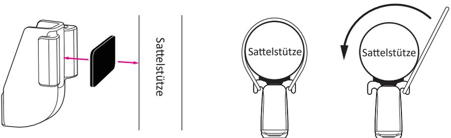
Das 2-seitige Klebeband zwischen der Halterung und der Sattelstütze anbringen.
