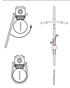
Diese Lampe ist für den Einsatz am Farrad bestimmt, dessen Sattelstütze im 73 Grad Winkel steht. Die Anbauhöhe liegt zwischen 250 mm und 1200 mm. Wenn Sie die Höhe der Sattelstütze ändern dann ändert das die Montagehöhe der Lampe.
