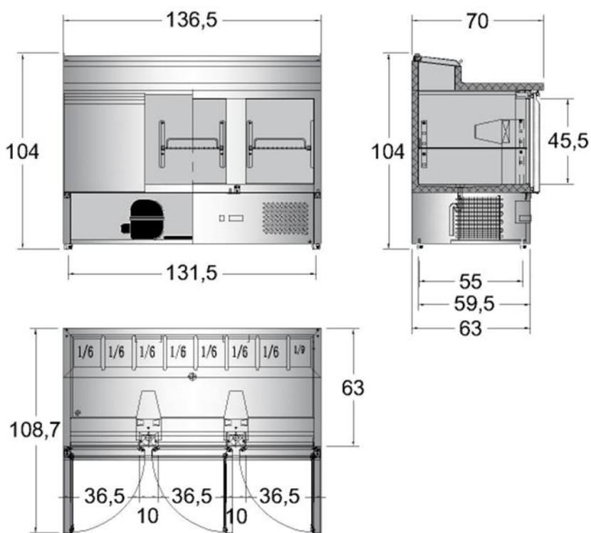
“La altura total del equipo puede variar según la dimensión de la rueda, confirmar tamaño de ruedas preinstaladas antes de realizar la compra”
