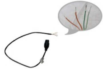
Anschluss mit RJ45- Stecker in der Box
