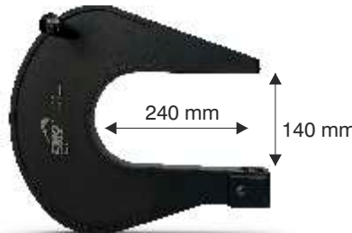
◀ Trancia 10 Ton idraulica per il taglio della lamiera. Utilizzabile per la foratura con punzoni da 0,6 mm e da 0,8 mm. Questo accessorio è necessario per la foratura della nuova lamiera in alluminio e per la calibratura dei fori esistenti delle lamiere in alluminio e in acciaio. Foratura della lamiera in acciaio al boron fino a 3 mm.
