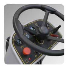
panel de control, el operador puede ajustar la velocidad de trabajo y la cantidad de solución de limpieza, selecciónando la opción más adecuada para cada tipo de suciedad. El trabajo se simplifica y hace más rápido gracias a el sistema automática de levantamiento de la boquilla de secado y de los cepillos
