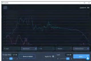
Abbildung 8: Der Anpassungsbildschirm zeigt einen guten Rauschpegel, deutlich unterhalb der Messkurve.
