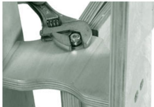
3. Desenrosque la tuerca de la parte de abajo del tren delantero.
