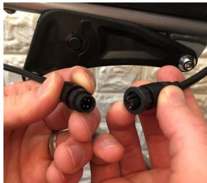
Connectez l'unité centrale au faisceau de câbles du contrôleur
