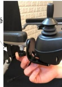
1. Connectez le faisceau de câbles du contrôleur au faisceau de câbles de l'unité centrale qui part du fauteuil lui-même, en prenant soin d'aligner correctement les broches afin qu'elles ne se plient pas, ne se cassent pas ou ne soient pas endommagées. Fixez la connexion en tournant l'anneau d'accouplement sur le harnais raccordé.
