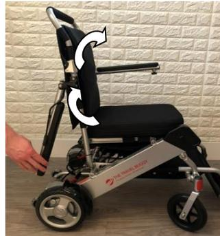
1. Glisser le contrôleur dans la fente ouverte du bras de la CITY sur le côté droit (à moins qu'il ne soit précommandé pour les utilisateurs gauchers). Serrez le bouton situé sous l'accoudoir pour fixer le contrôleur en place.
