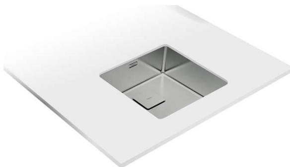
**Sobrepuesto** El lavaplatos se instala por la parte superior de la cubierta, las pestañas del lavaplatos estan pulidas igual que la cubeta, para no crear 2 tonos de acero. Se usan grapas especiales para este tipo de instalación, (provistas en el embalaje del producto) estas grapas son similares a un clip que sujeta el lavaplatos a la cubierta, despues de apretar unos tornillos.
