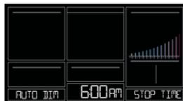
**Remarque :** Si vous pressez le bouton « LIGHT » (éclairage) pour régler manuellement le rétroéclairage, la fonction d'atténuation automatique sera activée de nouveau à l'heure préréglée de la prochaine diminution de l'éclairage.
