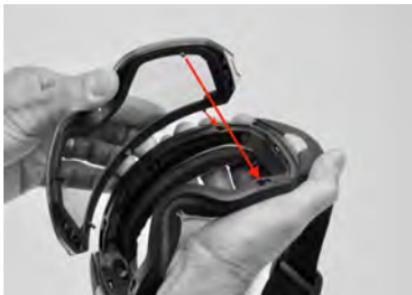
1. Установите линзу в правильной ориентации и вставьте опорные штифты на рамке с одной стороны линзы в прямоугольные приемные отверстия на корпусе.
