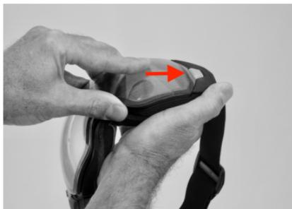
3. Tenendo saldamente il bordo della montatura della maschera, far scivolare la lente nella direzione indicata fino a quando il bordo della lente si trova a filo dell'attacco del cinturino. Ruotare la maschera e ripetere questo passaggio per l'altro lato della lente.
