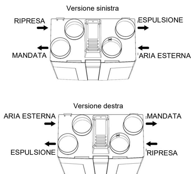
La configurazione destra/sinistra avviene in fase di avviamento tramite lo schermo LCD, senza ulteriori modifiche sull'unità. L'impostazione di fabbrica è in versione destra.
