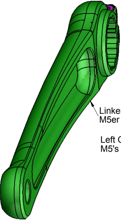
Linker Kurbelarm mit zwei M5er Imbus Befestigungsschrauben
