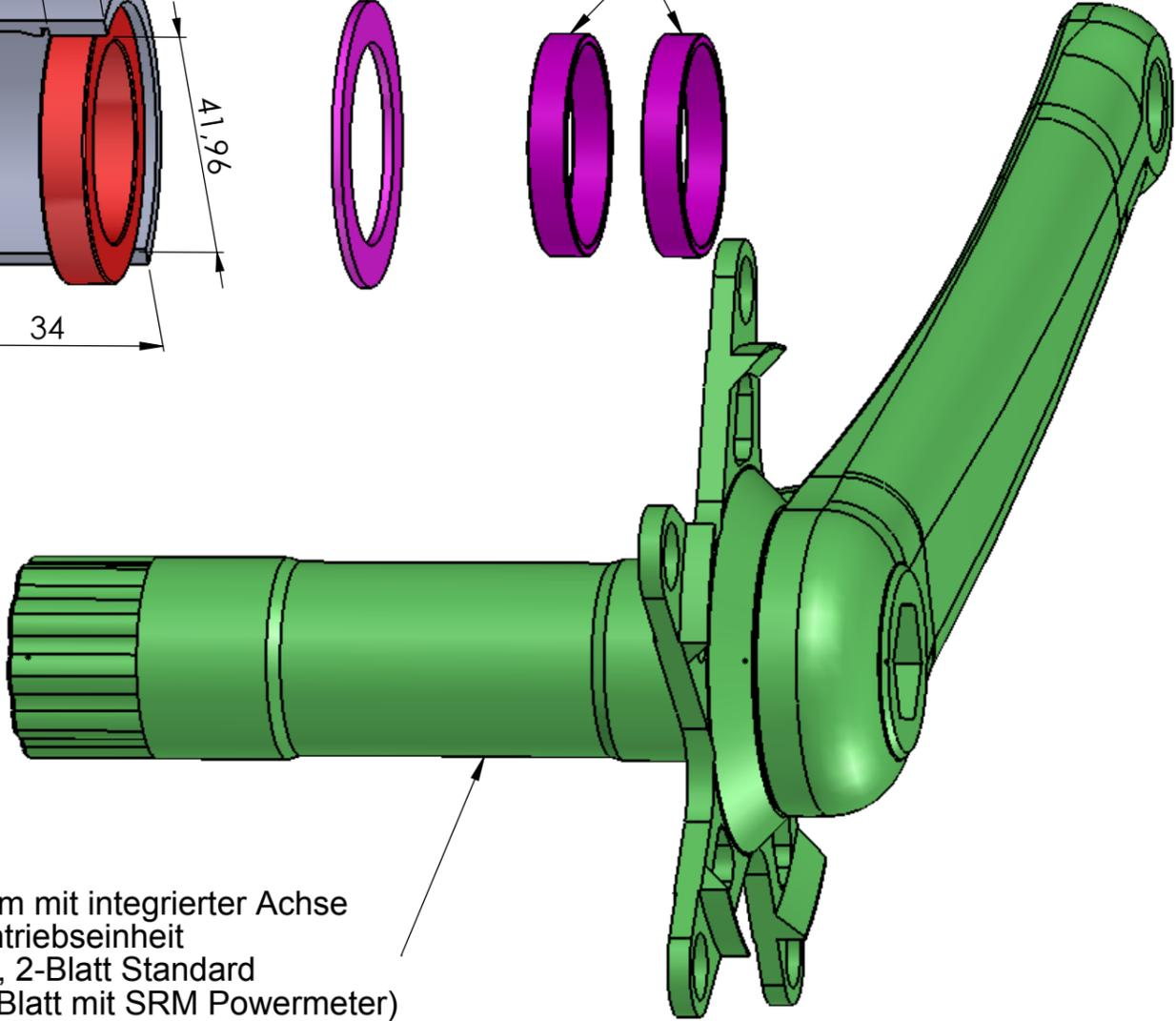
Rechter Kurbelarm mit integrierter Achse und arretierter Antriebseinheit (2-Blatt 110 BDC, 2-Blatt Standard 130 BDC oder 2-Blatt mit SRM Powermeter)
