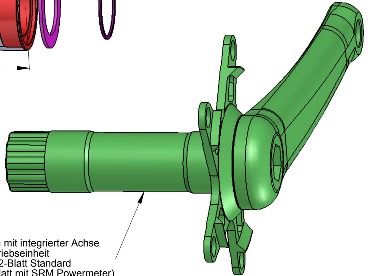
Rechter Kurbelarm mit integrierter Achse
