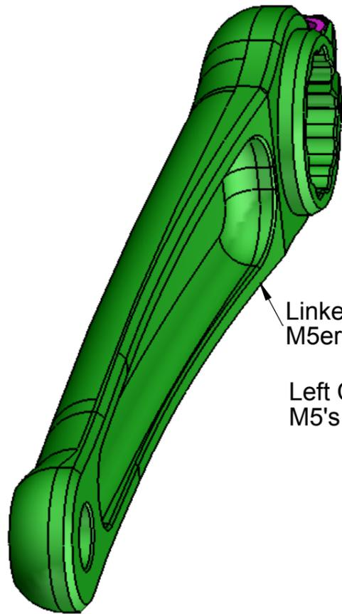
Linker Kurbelarm mit zwei M5er Imbus Befestigungsschrauben
