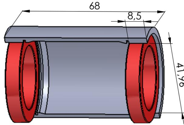
1,5 mm Lagerdichtung / Bearing Seal
