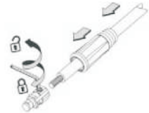
Photo 4-3 Système d'assemblage de la fiche rapide
