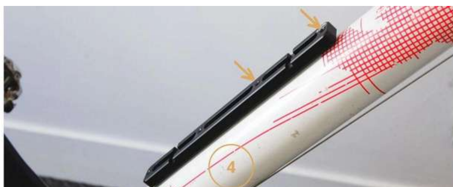
PHOTO 4 : Il sera indispensable pour ce kit. Il permet de déporter les trous de fixation d'une dizaine de centimètres vers le centre de votre cadre, ce qui va permettre de recentrer la batterie sur le cadre.
