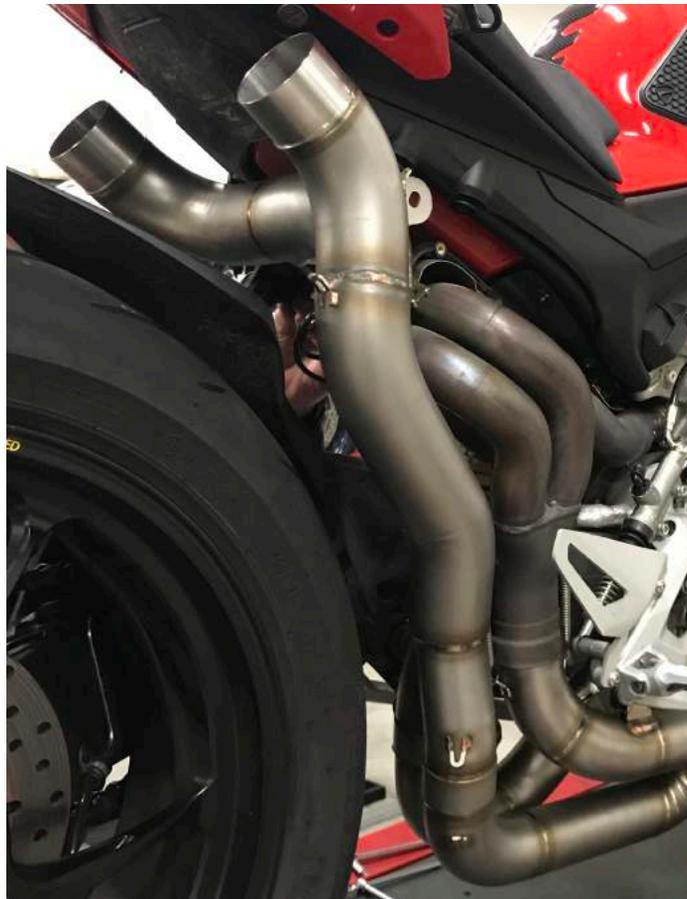
7. Fissare da entrambi i lati della moto le staffe telaio al raccordo utilizzando vite, dado e distanziali in dotazione, tenendo all'interno le staffe del raccordo.
