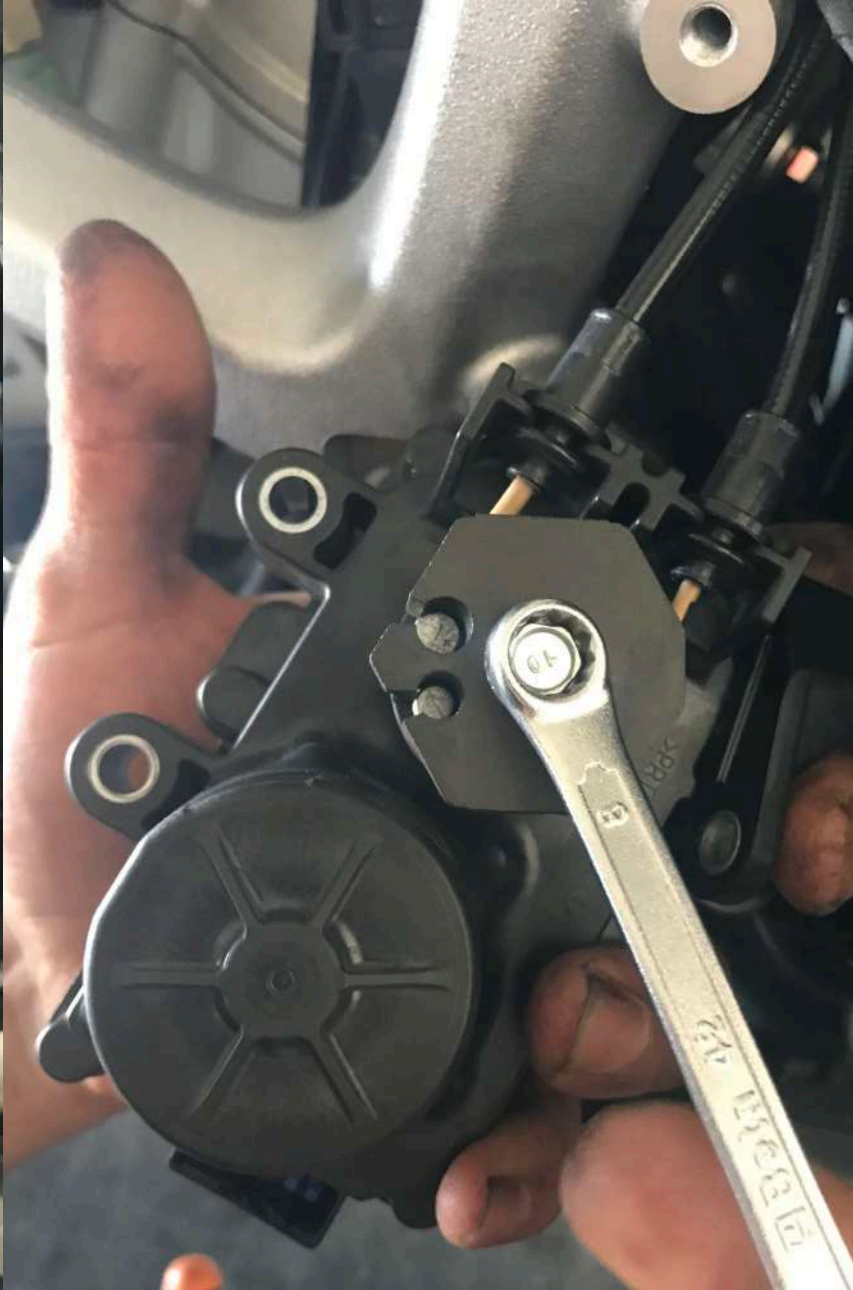
Rimuovere i due cavi dalla valvola allentando il bullone Loosen the nut and remove the valve cables
