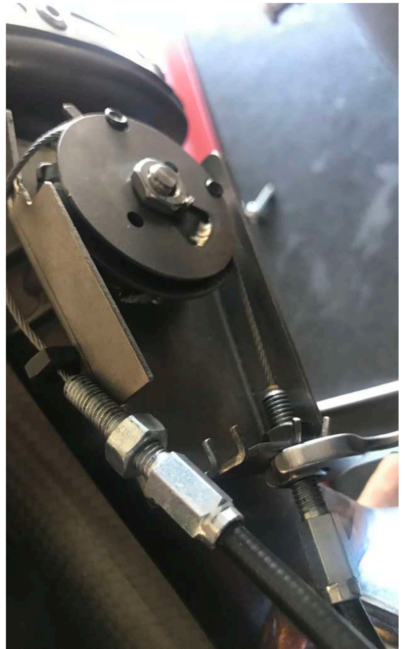
Rimuovere entrambi i cavi dalla valvola originale allentando i 2 bulloni / Loosen the nuts and remove the valve cables
