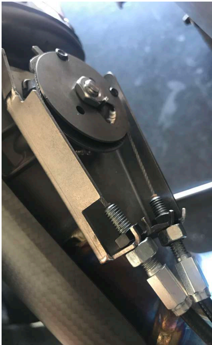
Rimuovere entrambi i cavi dalla valvola originale allentando i 2 bulloni / Loosen the nuts and remove the valve cables
