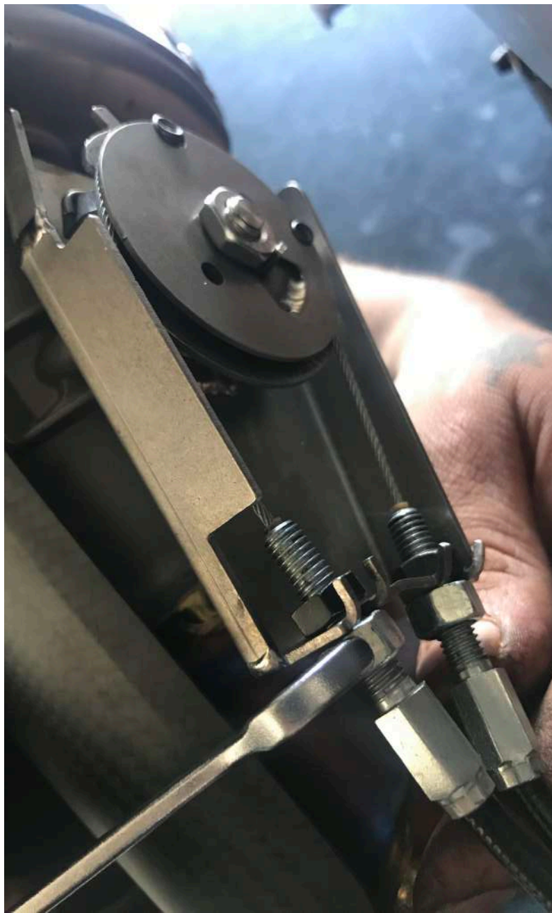
Rimuovere entrambi i cavi dalla valvola originale allentando i 2 bulloni / Loosen the nuts and remove the valve cables
