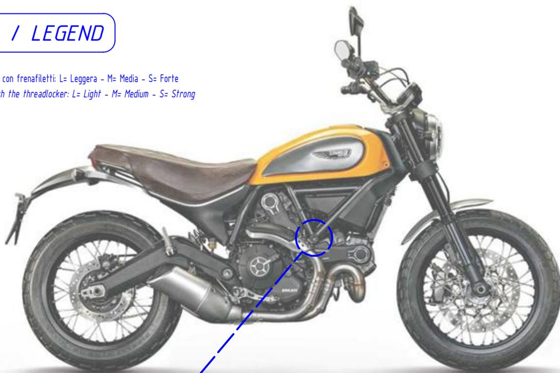
Svitare il dado posto sul lato DX/R (lato freno) ed estrarre la vite speciale secondo quanto previsto dal manuale del costruttore.
