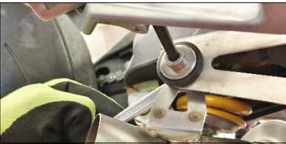
Avvitare silenziatore alla staffa di fissaggio con la vite testa cilindrica M8x30 (18) e rondella (19) e dado autobloccante M8 (25)
