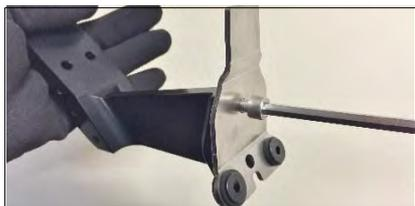
Fissare la staffa lato telaio con la staffa supporto silenziatore nera con due viti 8x10 (49)
