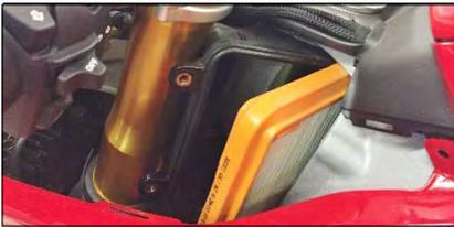
Sfilare il filtro aria e mettere il filtro (8) in dotazione
