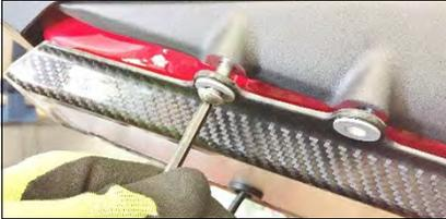
Fissare il particolare ai 4 fori delle pedane passeggero usando le quattro viti (52) senza serrare
