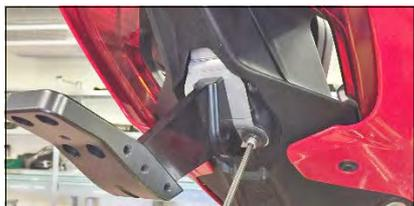
Inserire la staffa nell'alloggiamento sotto coda e avvitare con le viti 5x20 (50)
