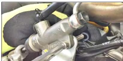
Avvitare la pompa del freno nel foro superiore con la vite 6x35 (53) e distanziale (44) in dotazione e invece nel foro inferiore con la vite 6x16 (48)
