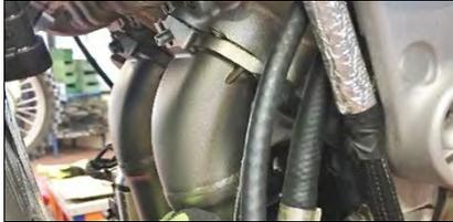
Inserire gli attacchi testa e avvitare con i due dadi in dotazione (24) le viti superiori degli attacchi testa, per quelle inferiori usare i dadi di serie, quindi serrare
