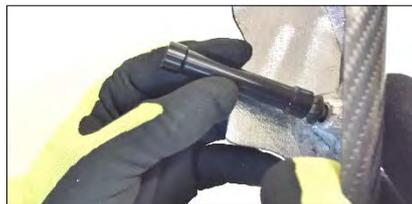
Posizionare il distanziale piccolo con collare (36) e il distanziale lungo nero anodizzato (47) all'interno del paracalore.
