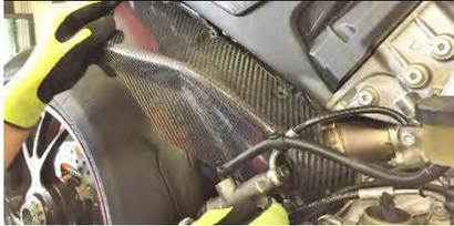
Ora posizionare il paracalore laterale destro (7) e fissarlo al telaio con le due viti nere 5x12 in dotazione (38) e fissarlo alla pompa freno usando la vite 6x35 (53) e il distanziale (44) e dado (43)
