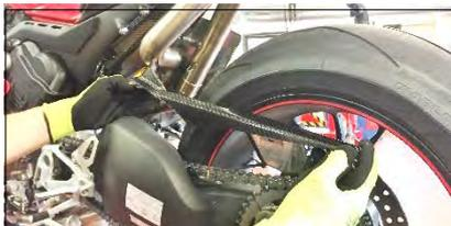
Posizionare il parafango (3) e avvitarlo con le tre viti in dotazione (38) e usare una fascetta in plastica (32) per fermare il cavo del conta km.
