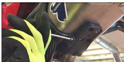
Fissare il paracalore alla staffa sotto il silenziatore usando con le viti 5x12 in dotazione (51)
