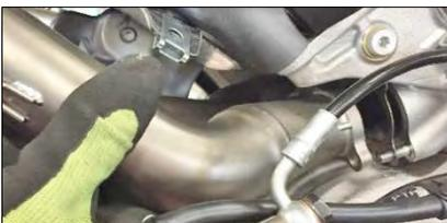
Fissare l'attacco testa posteriore sinistro con i tre dadi in dotazione (41) e serrare
