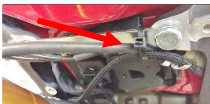
Bloccare i cavi della sonda lambda tramite fascetta (32) come indicato
