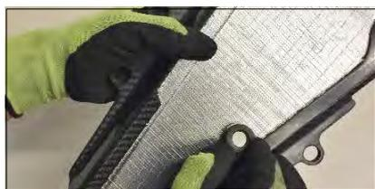
Inserire il gommino passacavo (55) nel foro centrale del paraserbatoio in carbonio
