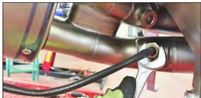
Inserire la sonda lambda nell'apposita sede sul collettore e avvitare
