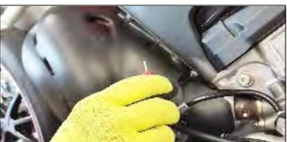
Rimuovere le 5 viti del paracalore collettore posteriore
