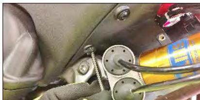
Spostare il semiguscio destro del paracalore collettore posteriore
