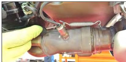
Rimuovere le molle del collettore posteriore e del collettore anteriore
