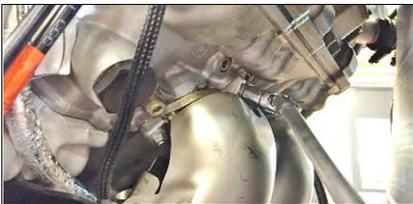
Svitare sonda lambda collettore inferiore
