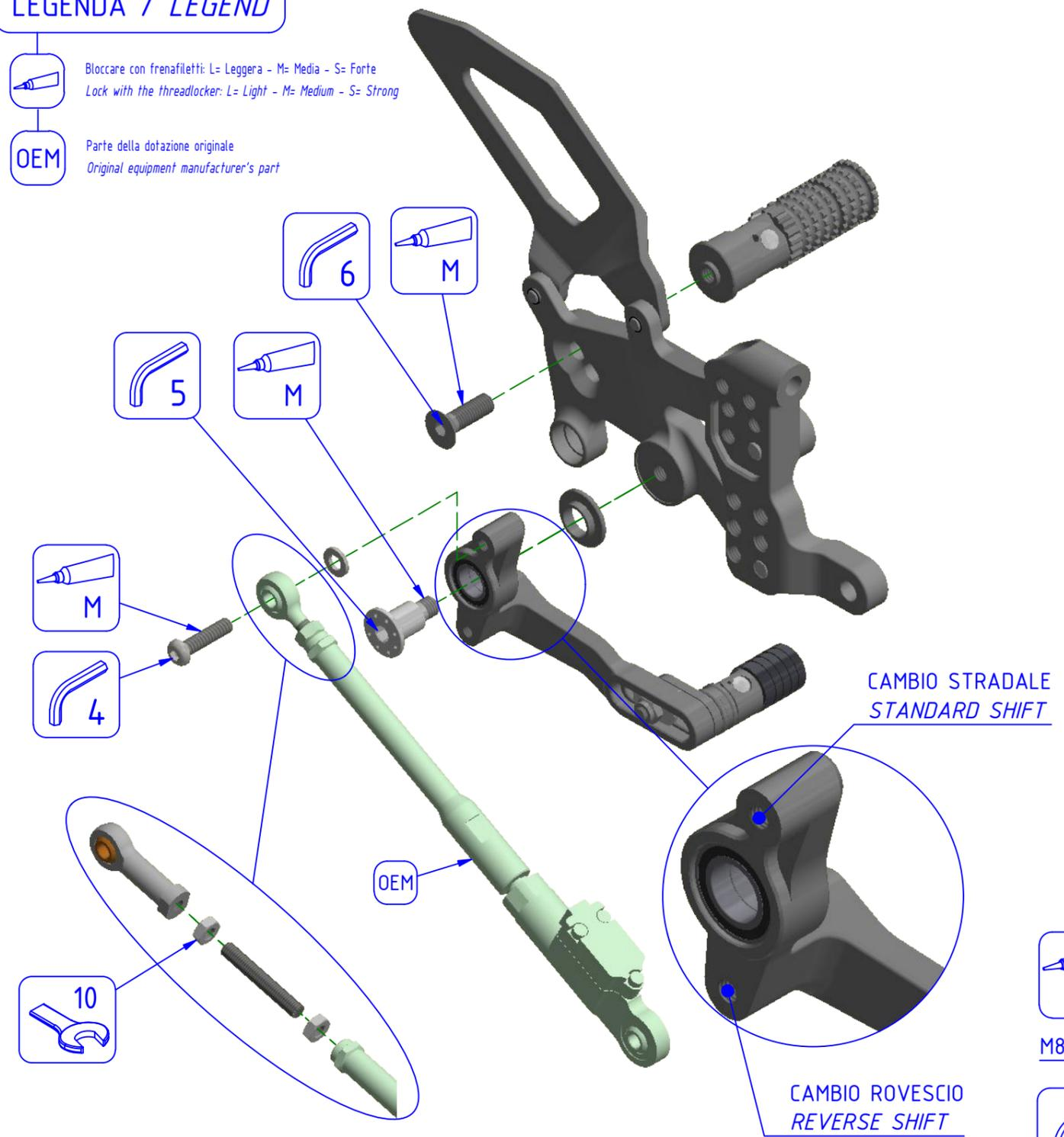
Per alcune configurazioni sostituire uniball OEM secondo lo schema indicato
