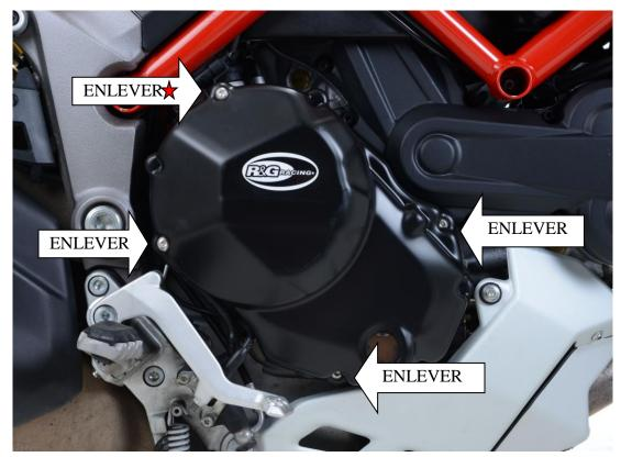
Le kit doit contenir : 1 x Protection Carter Moteur (ECC0205) 2x M6 x 40mm Boulons 1x M6 x 90mm Boulon 1x M6 x 100mm Boulon 1x M6 Rondelle
