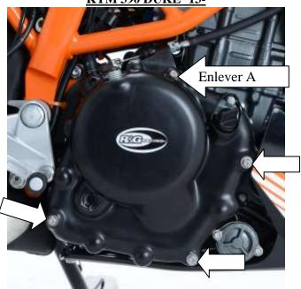
Le kit doit contenir : 1 x Protection carter moteur (ECC0165). 4x M6 x 45mm Boulon 3x M6 Rondelles
