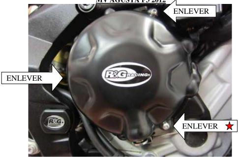
Le kit doit contenir: 1 x Protection carter moteur (ECC0147) 3 x M6x35mm Boulons à tête ronde 1 x M6 Rondelle
