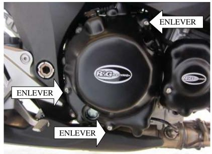
Le kit doit contenir: 1 x Protection carter moteur (ECC0144) 3 x M6x40mm Boulons à tête ronde 3 x M6 Rondelles
