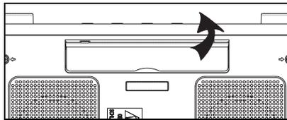
1. Klappen Sie den Stützfuß auf der Geräte-Unterseite vollständig heraus.
