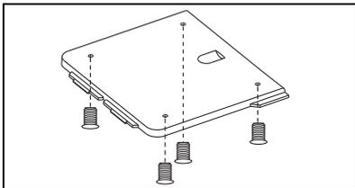
4. Schrauben Sie die Montageplatte mit den **kurzen** Schrauben fest.
