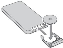
1. Drücken Sie den kleinen Hebel an der Seite des Batteriehalters etwas in Richtung Mitte und ziehen anschließend den Batteriehalter in Pfeilrichtung aus der Fernbedienung.
