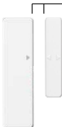
Separación: menos de 19 mm cuando está instalado.
