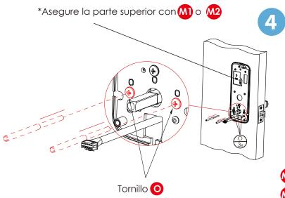
Quite las varillas de posición V y reemplácelas con tornillos O Ajuste en sentido de las agujas del reloj hasta que la placa de montaje quede firme.
