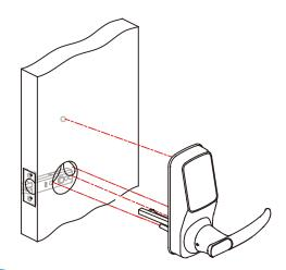
Instale la chapa exterior como se muestra a la izquierda alineando la chapa recta y pasando el cable y varillas a través de la chapa.
