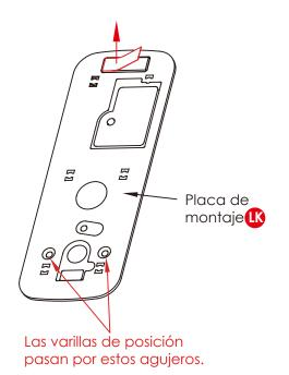
La placa de montaje interior li irá contra el lado interior de su puerta. Retire la capa de papel del Cinta adhesiva y alinee el varillas de posicionamiento en la parte inferior de la placa con los agujeros correspondientes a la izquierda y derecha.
