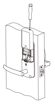
8 Inserte 4 baterías AA en la chapa alineando las marcas de orientación positiva (+) y negativa (+) de las baterías en el compartimento de la batería.
