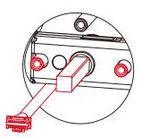
Pase el eje **©** a través el centro de la chapa, y las varillas redondas a través de los lados en sus respectivos agujeros. El cable debe pasar por debajo de la chapa.
