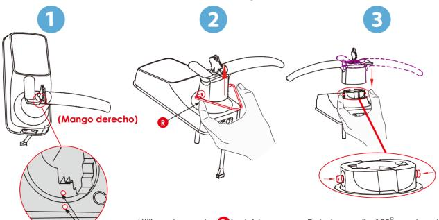
Inserte la llave y rote para alinear los dos puntos blancos, como se muestra en la imagen. Utilice el pasador Rincluido para empujar el pasador de metal ubicado en las 3 en punto de la base del mango, luego el otro pin en posición de las 9 en punto. Retire el mango una vez que los pasadores estén comprimido.
