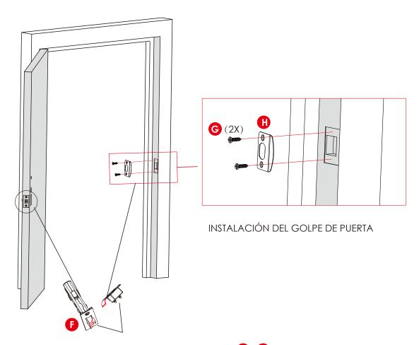
Asegúrese de que el lado inclinado del Latchbolt (f)/(2) se cierre contra la parte inclinada de la placa de impacto (H) antes de fijarla en el marco de la puerta.
