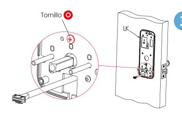
Tire el cable desde el exterior de la chapa a través del agujero rectangular debajo de las varillas de posición y del eje.
