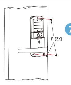
Una vez que el interior de la chapa esté al ras de la placa de montaje, asegure la chapa a la placa atornillando en el sentido de las agujas del reloj usando tornillos incluidos **P**.
