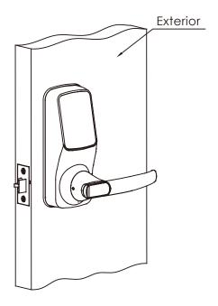
Ponga la chapa derecha y presione con fuerza (si usa la cinta adhesiva en el paso 3.4) para sujetar la parte superior de la chapa.
