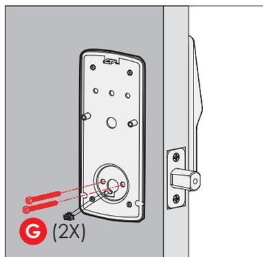
**3:** Inserte y apriete a mano 2 **G** tornillos ubicados a la izquierda y derecha de la hoja. Compruebe la alineación y apriete con un destornillador hasta que el montaje de la placa esté colocado de forma segura en la puerta.
