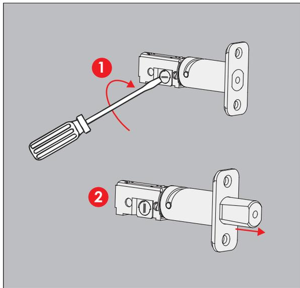
Inserte el cerrojo en la mortaja al ras con el borde de la puerta, asegúrese de que el lado derecho esté hacia arriba y la ranura está en posición vertical. Asegúrelo con 2 **K** tornillos.
