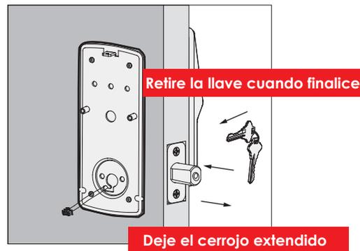
**4:** Utilice la llave para asegurarse de que los cerrojos se desbloqueen suavemente (sin atascamiento ni fricción). **IMPORTANTE: cuando termine, deje el cerrojo extendido y retire la llave antes de pasar al siguiente paso.**
