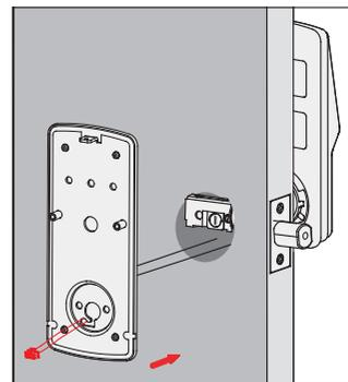
**2:** Alinee y asegure la placa de montaje con las tiras adhesivas. Guíe los cables de conexión a través del orificio y asegúrelo al orificio inferior izquierdo.
