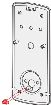
**1:** Compruebe la alineación de la placa de montaje interior (K) con el orificio de la puerta antes asegurarlo con tiras adhesivas.
