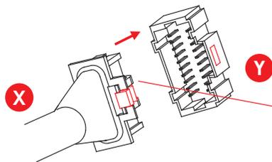
Enchufe **X** en **Y**, haga coincidir el lado rojo del conector con el rojo en el enchufe - insertar herméticamente.
