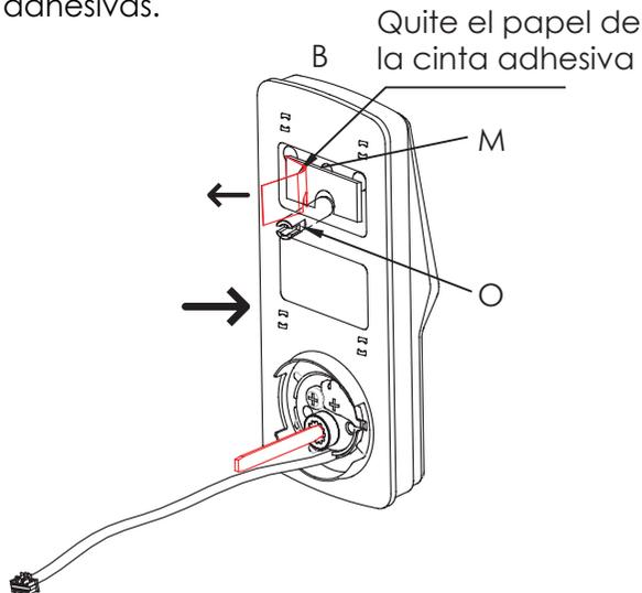
\*Este orificio (O) es para el barril ranurado opcional Extensión proporcionada para estabilizar su chapa. Eso requerirá perforar un orificio adicional en su puerta (Consulte la plantilla proporcionada). Además puede utilizar el adhesivo de doble cara incluido que cumple el mismo propósito si no desea hacer un agujero. Si hizo un agujero, apriete bien el poste con un destornillador de punta plana girándolo en el sentido de las agujas del reloj antes de montarlo en la puerta.
