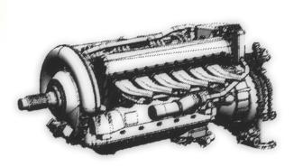
V-1650-7はロールス・ロイスが開発しパッカード社がライセンス生産した液冷V型12気筒 エンジンである。マーリンエンジンのライセンス生産品「V-1650-1」の過給機制御をライ ト社製に置き換えたものを「V-1650-3」と呼ぶ。これはP-51B/C初期型に採用されたタ
