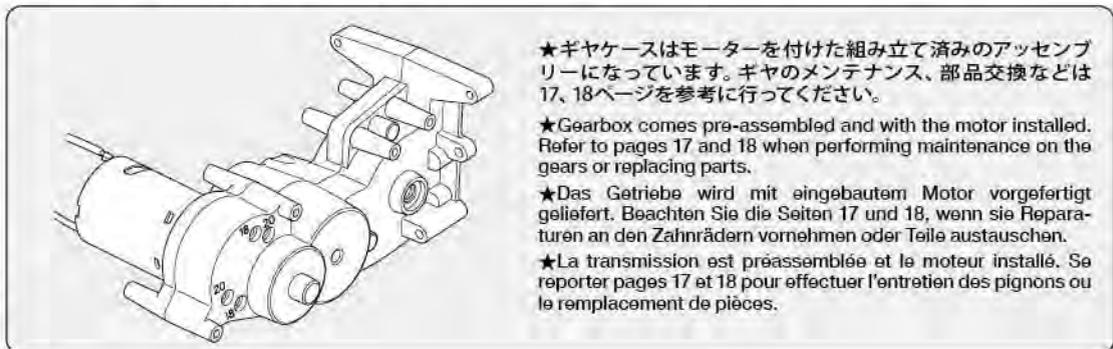
★ギヤケースはモーターを付けた組み立て済みのアッセンブリーになっています。ギヤのメンテナンス、部品交換などは17、18ページを参考に行ってください。
