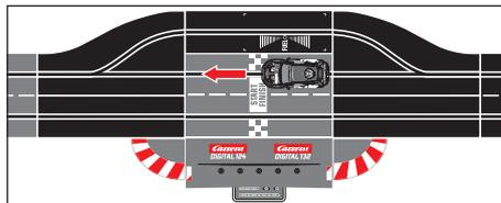
Le logo « FUEL » sur la Pit Stop Adapter Unit doit être lisible dans le sens de la course.
