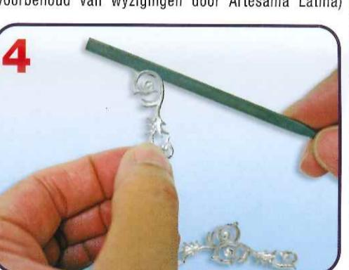
● Para que las piezas de metal fundido le ajusten perfectamente, antes de colocarlas repase los cantos y elimine las posibles rebabas e impurezas con la ayuda de una lima pequeña.
