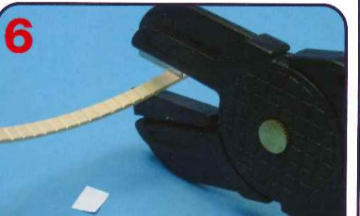
● El plegalistones es una herramienta diseñada para producir pequeñas incisiones en listones de madera con el fin de curvarlos. Esta especialmente indicado para el forrado de un casco.
