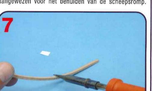
● Sumerja los listones de madera en agua caliente entre 30 minutos y 2h. dependiendo de su grosor y textura. con la ayuda de una fuente de calor (lo ideal es un soldador electrónico) ejerza presión deslizante por el interior de la curva. repita el proceso hasta conseguir la curvatura deseada.
