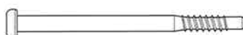
BB5 ×2 19400233 リアダンパーシャフト Rear damper shaft Hintere Kolbenstange Axe de piston arrière
