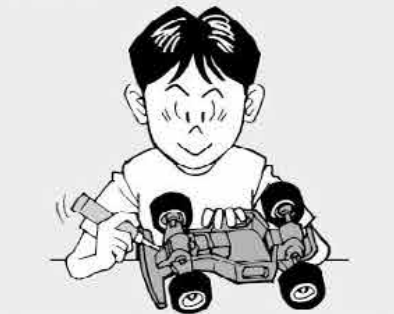
⑧ ギヤや軸受け部、サスペンションなどの可動部はグリスをさしておきましょう。
