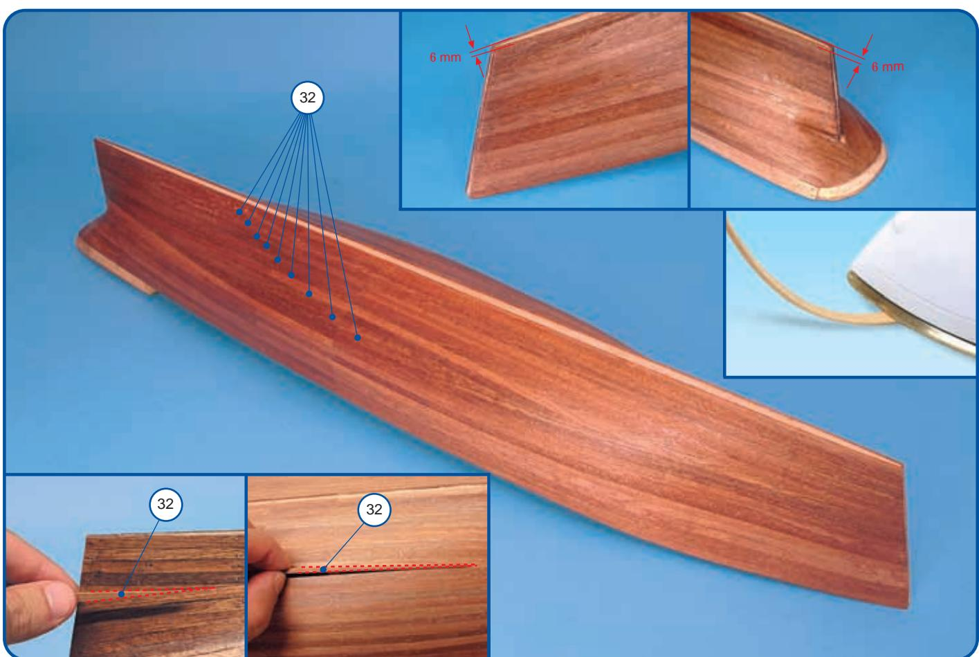
Encol y clave las amuradas 34 justo encima de las primeras tracas que se colocaron en el paso anterior. Encol en proa y entre las dos amuradas 34 el soporte del bauprés 35.
