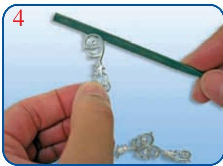
**4.** Para que las piezas de metal fundido le ajusten perfectamente, antes de colocarlas repase los cantos y elimine las posibles rebabas e impurezas con la ayuda de una lima pequeña.
