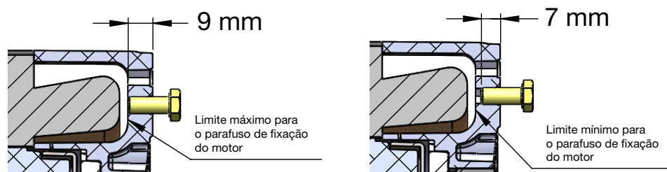
Figura 38 - Límite de profundidad del engaste
