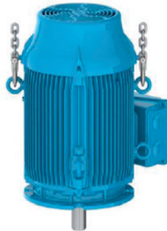
Figura 22 - Instalación del primer par de cáncamos
