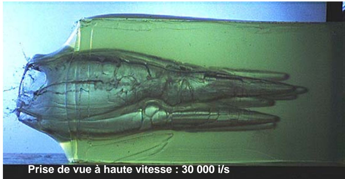
Chevrotines Cal. 12 dans gélatine à 10%
