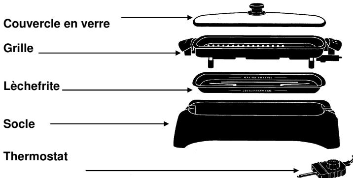
Suivez les instructions d'assemblage ci-dessous pour monter correctement le bouton du couvercle avant usage. N'utilisez pas le couvercle sans que le bouton soit correctement fixé sur le dessus du couvercle.
