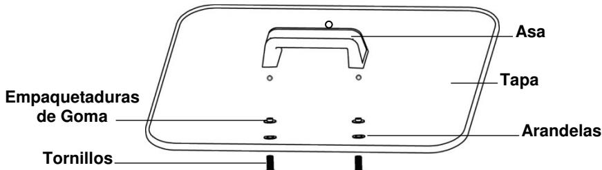
Los herrajes requeridos para fijar el asa a la tapa podrían estar empaquetados en una pequeña bolsa plástica o dentro del asa misma. Para las tapas de vidrio, alinee el asa con el orificio en la tapa, y luego atorníllela usando el conjunto de tornillos, arandelas y empaquetaduras en el orden arriba indicado. **NO** apriete de más.
