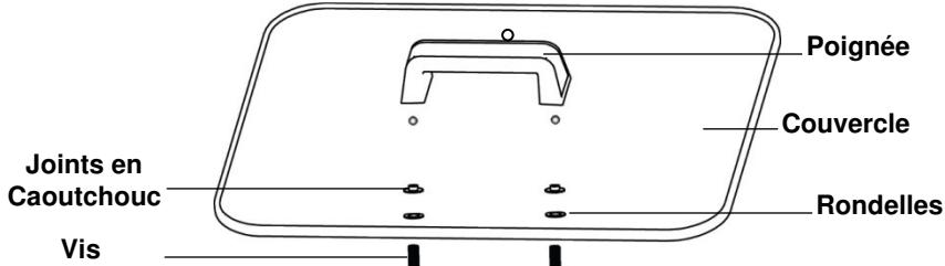
La quincaillerie nécessaire à la fixation de la poignée peut être emballée dans un petit sachet de plastique ou se trouver à l'intérieur de la poignée elle-même. Pour les couvercles de verre, alignez la poignée avec le trou dans le couvercle, puis fixez avec l'assemblage de vis en respectant l'ordre indiqué ci-dessus. Veuillez **NE PAS** serrer de manière excessive.
