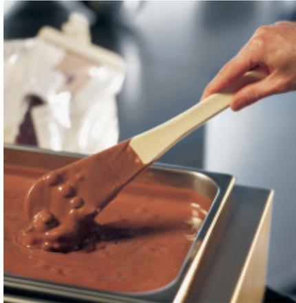
**2/** Ajusta la temperatura de la fundidora a la temperatura ideal de pre- cristalización del chocolate con el que estás trabajando.
