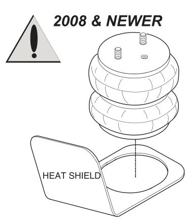
ON 2008 & NEWER VEHICLES, INSTALL HEATSHIELD BETWEEN THE AIR SPRING & THE LOWER BRACKET
